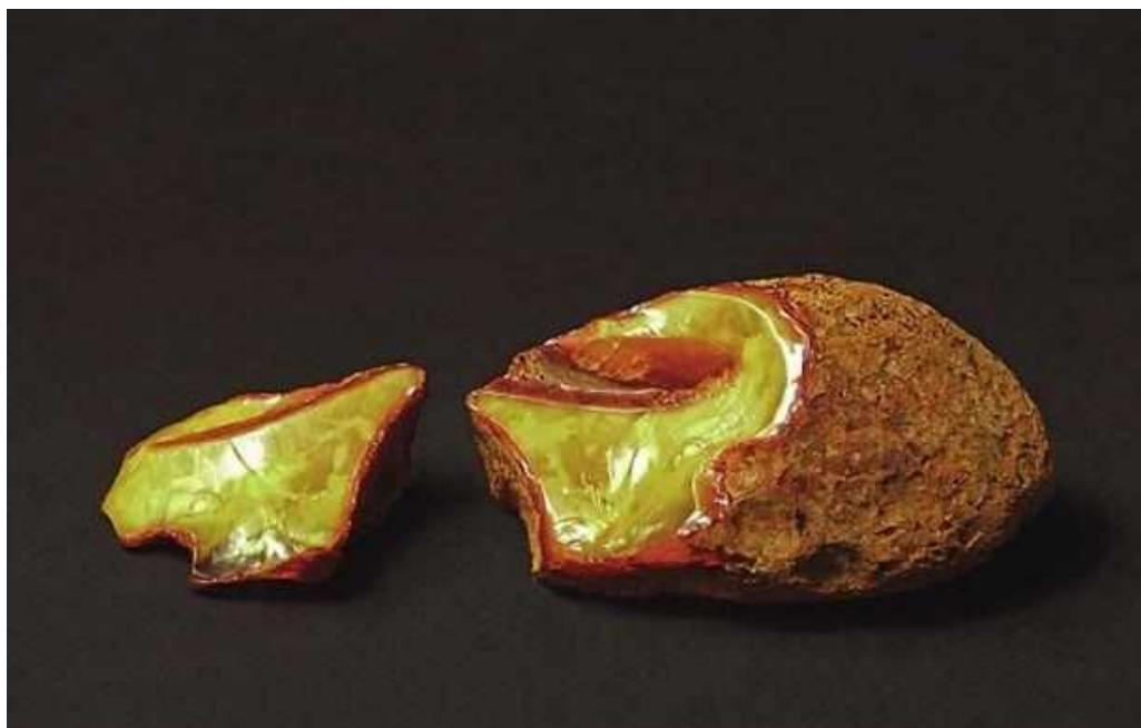
Рис. 2.2.1. Образец янтаря с выветренной поверхностью, покрытой толстой окисленной корочкой и трещинами
