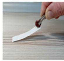
Вывод: янтарь и смола могут электризоваться при трении, но не обладают способностью проводить электрический ток. Они являются диэлектриками
