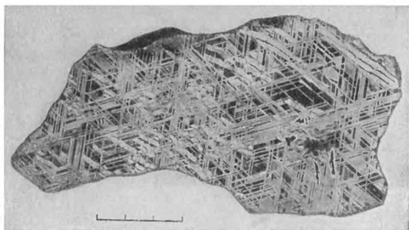
*Видманштейновы фигуры на протравленной поверхности пластинки, выпиленной из железного метеорита*
