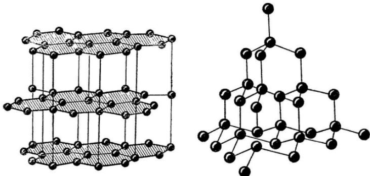
*Алмаз и графит состоят из атомов углерода, но располагаются атомы в этих минералах различно. В алмазе (справа) каждый атом окружен четырьмя атомами углерода на равных расстояниях (тетраэдр). У графита (слева) атомы расположены слоями, связи атомов между слоями ослаблены*
