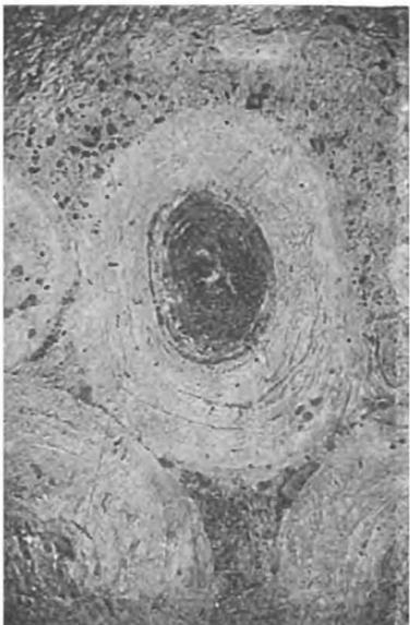
Микроскопическая картина строения оолитов марганцевых руд. Снято в отраженном свете
