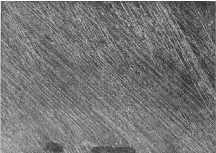
*Неймановы линии на протравленной поверхности пластинки, выпиленной из железного метеорита Богуславка*
