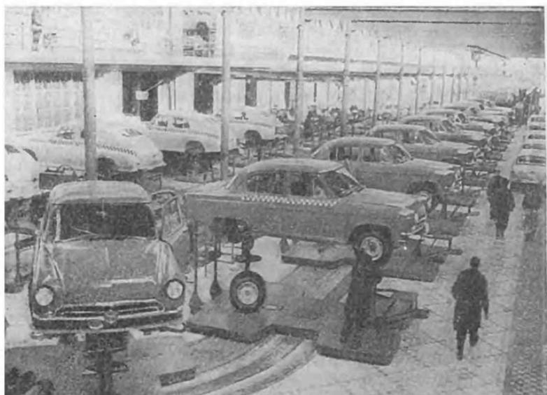
Легковые автомобили «Волга» на конвейере
