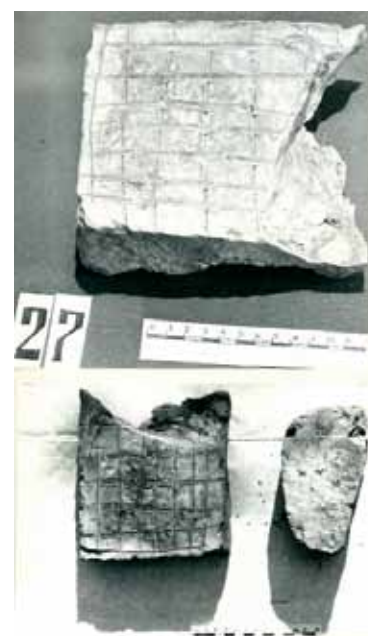
235. Кирпичи XVII в. ТИМАХМ: а) с расчерченной в клетку постелистой поверхностью; б) с процарапанной буквой «фита»
