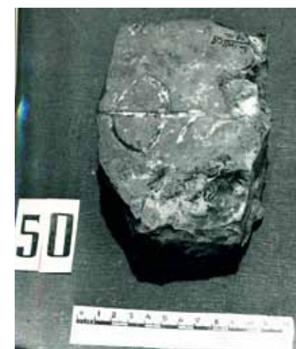
235. Кирпичи XVII в. ТИМАХМ: а) с расчерченной в клетку постелистой поверхностью; б) с процарапанной буквой «фита»
