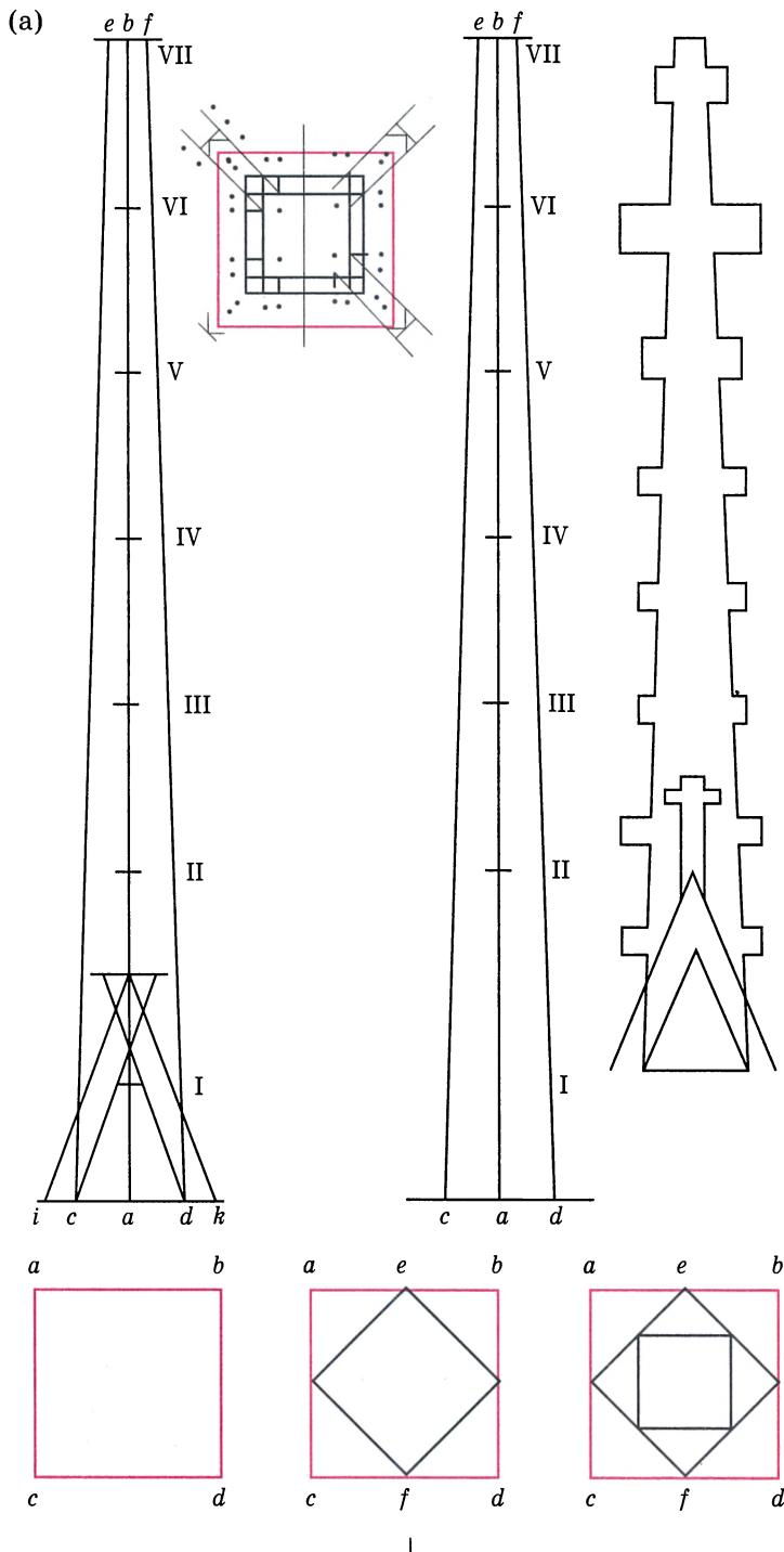
Чертежи для конструирования готических башен
