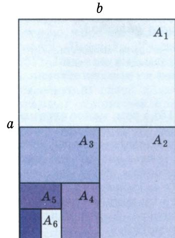
Построение основного формата бумаги *RA* с помощью геометрической прогрессии ( $q = \sqrt{2}$ ), сохраняющей пропорции прямоугольного листа при фальцовке.
