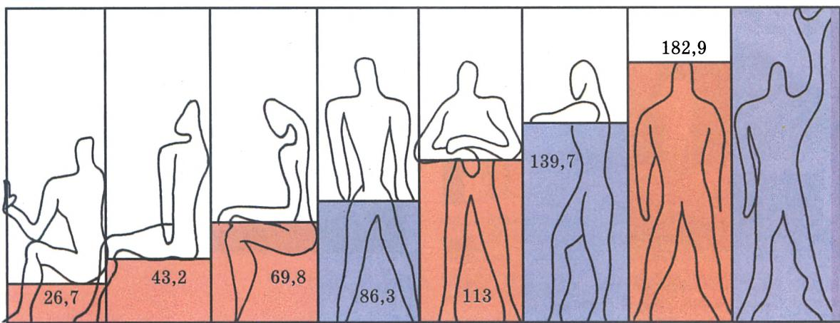
Числа красной и синей шкал модулора — действительные размеры, соответствующие определенным положениям тела человека. Рисунок Ле Корбюзье.
