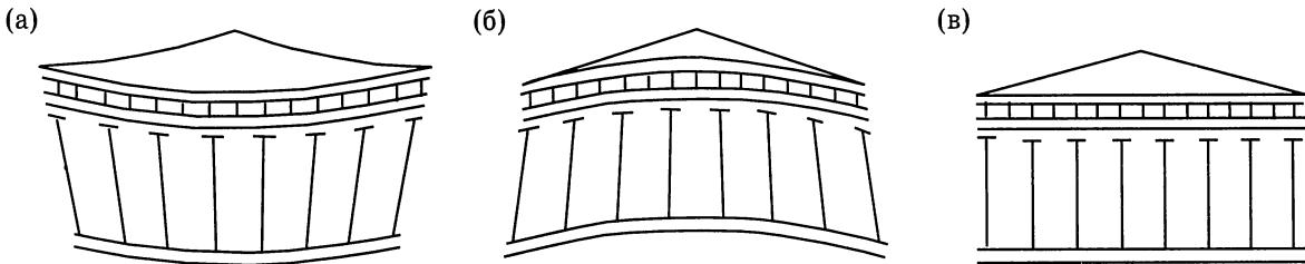
Оптические иллюзии восприятия. Так выглядел бы Парфенон, если бы его линии были строго горизонтальны и вертикальны (а). Таков Парфенон в действительности (б). Парфенон, каким мы его видим благодаря оптическим поправкам (в). Наклоны и искривления прямых сильно преувеличены.
