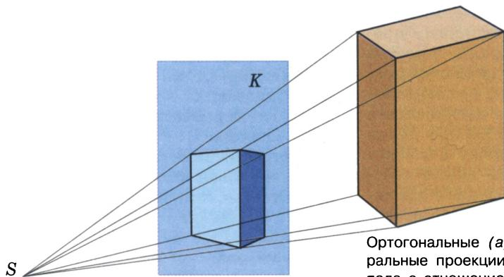
Ортогональные (а), аксонометрические (б) и центральные проекции (в) прямоугольного параллелепипеда с отношением сторон 1:2:3.
